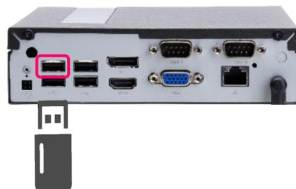
**Step2** MC3000にキーボード、マウス、ディスプレイを接続した後、電源ボタンを押して起動させます。
